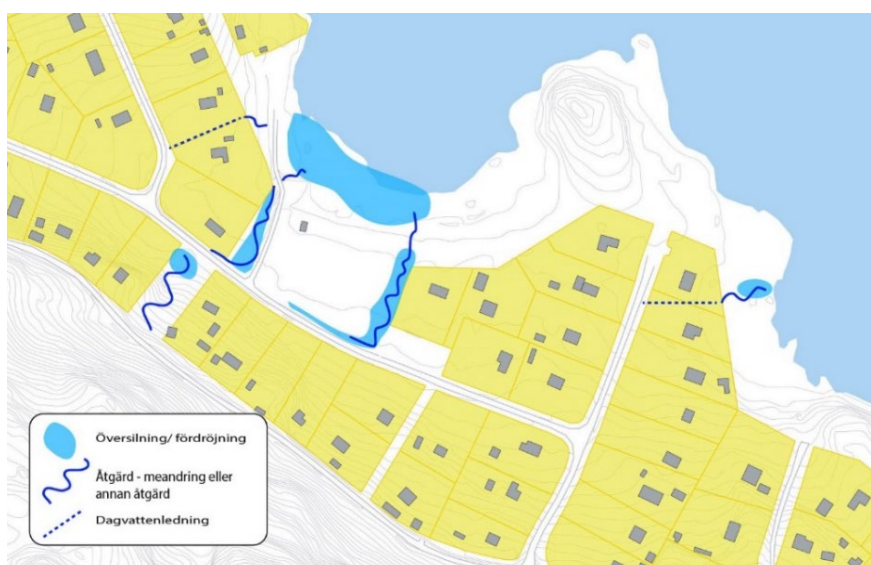
Exempel på platser med befintliga ekosystemtjänster och där åtgärder kan förbättra dagvattenreningen.
